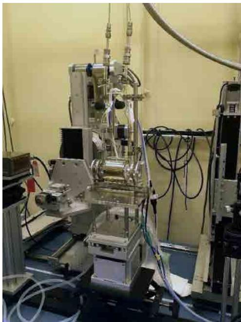
図 2. 透過 XAFS 用石英セルの実験配置。
